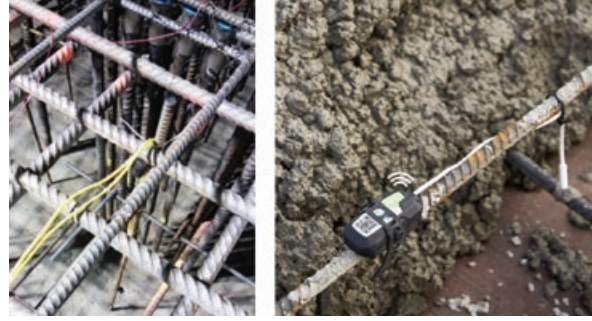
Sıcaklık ölçüm yöntemleri: Kablolu ölçüm ve kablosuz ölçüm
